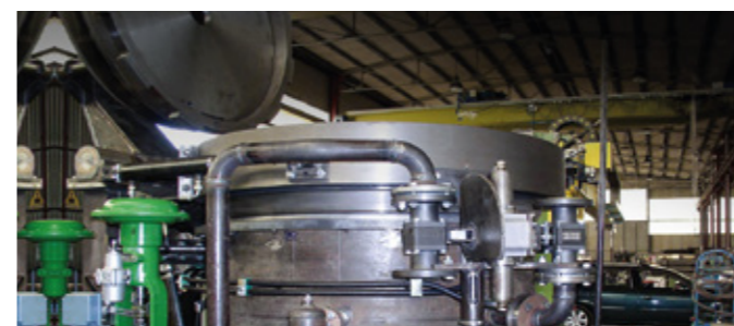
AUTOCLAVE VERTICALE IN ESECUZIONE SPECIALE: SOLLEVAMENTO DEL MANTELLO
